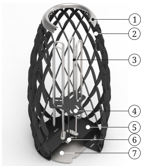
Рисунок 2. Расположение основных элементов электрокаменки «Мэри Экс».
